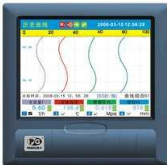
产品特点：FI-1002 [万能输入彩屏无纸记录仪](#)，可输入标准电流、标准电压、频率、毫伏、热电偶、热电阻等信号。具有传感器隔离配电输出、继电器报警输出、变送输出、流量积算、温压补偿、历史数据转存、打印以及远程通讯功能。(http://www.fx-sensor.com 010-51295202)
