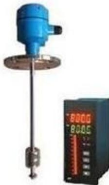
FL-107 插入式磁性浮球液位变送器，是将液位信号转变为 4~20mA 的连续电流信号或者电阻信号，通过电缆连接到二次显示仪表或控制室内，以便集中指示和观察。由本体、浮子、法兰盘或螺纹以及液位变送器等组成。可广泛应用于石油、化工、橡胶、医药、船舶、军事、电力、食品、水处理等行业的各种塔、罐、槽、球形容器和锅炉等设备作介质液面的位置指示和自动控制。
