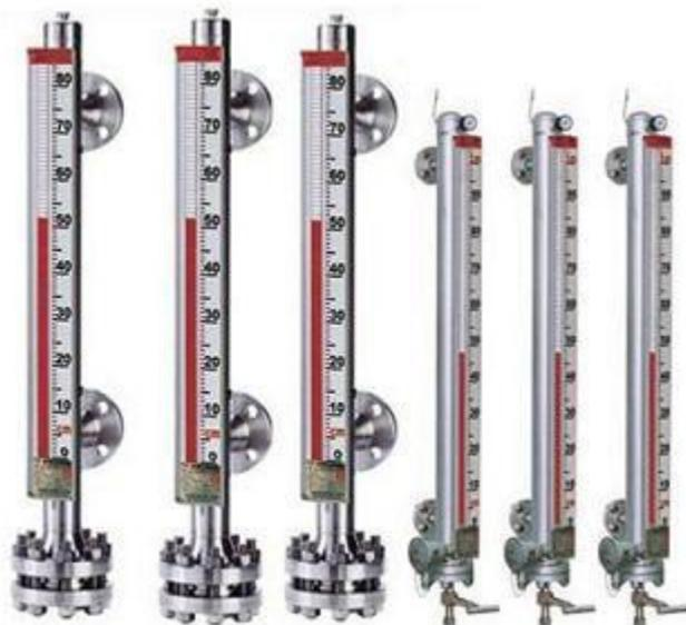
FL-201 [侧装式磁翻板液位计](#)是一种新颖的现场检测仪表，它的主体材质为不锈钢304/316、可全面取代玻璃管(板)液位计。液位计根据浮力原理和磁性耦合作用原理工作的。当被测容器中的液位升降时，液位计主导管中的浮子也随之升降，浮子内的永久磁钢通过磁耦合传递到现场指示器，驱动红、白翻柱翻转 180°，当液位上升时，翻柱由白色转为红色，当液位下降时，翻柱由红色转为白色，指示器的红、白界位处为容器内介质液位的实际高度，从而实现液位的指示。配电阻型、电流型、开关型远传配套仪表，或连接 DCS、PLC 系统或配上智能数显控制仪表，则可更方便地实现远距离检测、控制和报警。(http://www.fx-sensor.com 010-51295202)
