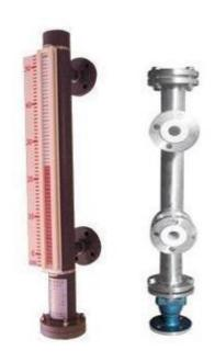
FL-205 防腐型磁翻板液位计是一种新颖的现场检测仪表,它的主体材质为 PVC/PP/不锈钢内衬四氟乙烯/不锈钢内衬 PP/不锈钢内衬 PVC,可全面取代玻璃管(板)液位计。它利用磁耦合原理,使介质和指示器完全隔离,使用更加安全可靠。该液位计指示清晰、观察方便,就地指示形式红白翻柱。配电阻型、电流型、开关型远传配套仪表,或连接 DCS、PLC 系统或配上智能数显控制仪表,则可更方便地实现远距离检测、控制和报警。
