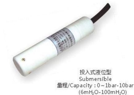
FL-411 系列采用陶瓷压阻芯片，耐强酸强碱的高聚合物高密度材质及防腐电缆，在 37%HCL 盐酸中长时间浸泡试验无异常现象，特别适用于现场有防腐要求的压力测量和控制。(http://www.fx-sensor.com 010-51295202)
