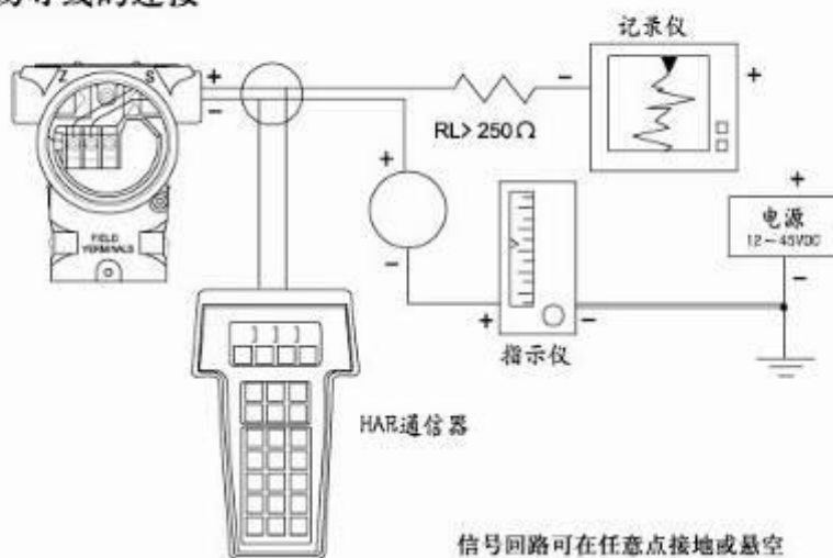
图 26 非智能型现场导线的连接
