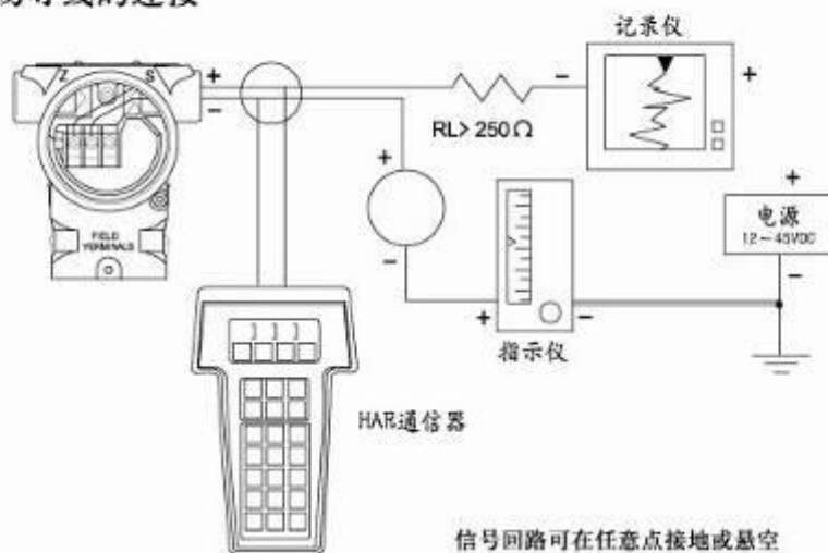
图 26 非智能型现场导线的连接
