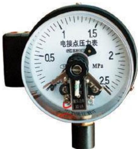
[电接点压力表](#)是用于测量对铜和铜合金不起腐蚀作用的气体、液体介质的正负压力，并在压力达到值时发出信号，接通控制电路，达到自动控制的报警得目的。(http://www.fx-sensor.com 010-51295202) 在电接点装置的电接触信号针上，装有可调节的永久磁钢，可以增加接点吸力，加快接触动作，从而使触点接触可靠，消除电弧，能有效的避免仪表由于工作环境振动或介质压力脉动造成触点的频繁关断。所以该仪表具有动作可靠、使用寿命长、触点开关功率较大等优点。
