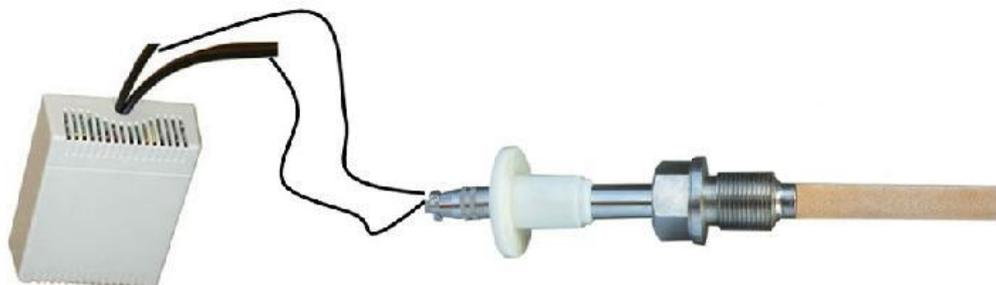
FH-302 [分体壁挂式温湿度变送器](#)为壁挂式，湿度传感器采用进口湿敏电阻元件，温度部分采用 NTC 或进口铂电阻 Pt100 作为感温元件。产品采用科学、合理的电路，保证产品的整体性能达到了较理想的效果。已获得客户广泛认可的直流电压或电流输出形式,可以配接二次仪表或采集卡。长期稳定性好，低漂移性；输出一致性好，互换性强；具有温度补偿，准确度好；适应领域广阔，抗腐蚀高；工作温度宽广，抗干扰佳。
